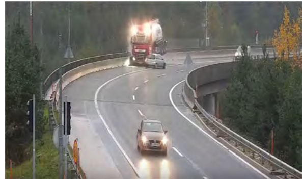
Рис. 1. Приклад дорожньо-транспортної пригоди, викликаній недостатнім поперечним нахилом віража на ділянці автомобільної дороги із значним нахилом осі поздовжнього профілю
