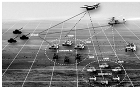
Рис. 1. Схема роботи системи «IFF» (Identification Friend or Foe)
