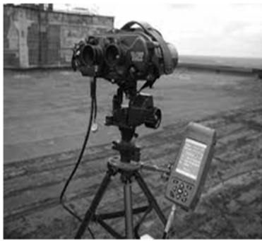
Рис. 5. Автоматизований комплекс розвідки СН 4003
