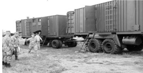
Рис. 3. Мобільний лазневий модуль, змонтований у 20-ти футовому контейнері
